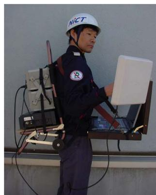
写真2 開発中のRFID書き込み読み取り装置
